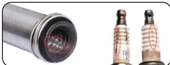
Flash Over na Vela e no Cabo de Ignição*
